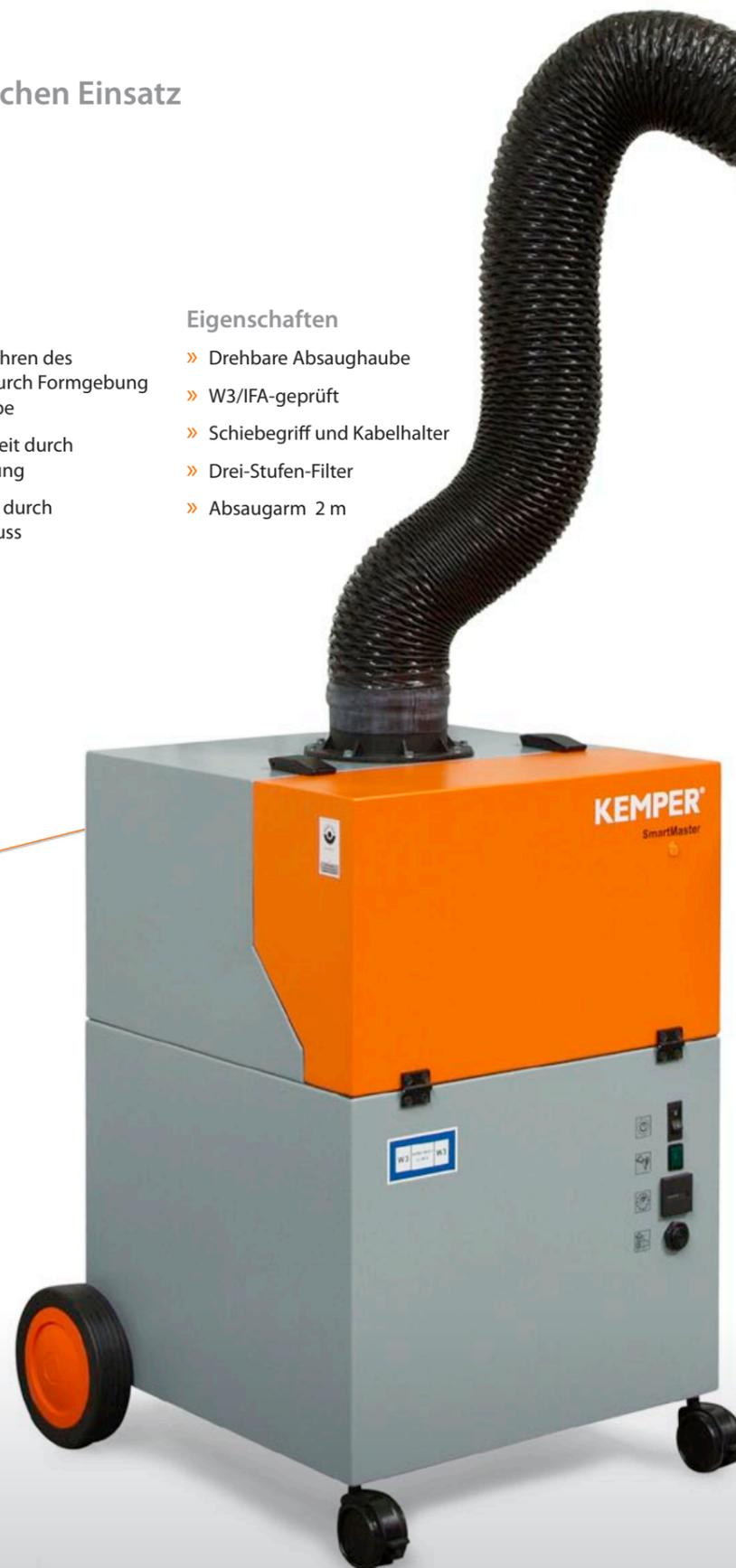
Das praktische Basisgerät ist für den sporadischen Einsatz mit geringen Staubmengen ausgelegt. Die dreh- und schwenkbare Absaughaube ermöglicht einen Einsatzradius von 360 Grad und sorgt für besonders wenig Nachführungen während des Schweißens. Das Basisgerät ist aufgrund seiner W3-Zulassung für das Schweißen von Chrom-Nickel-Stahl geeignet.
